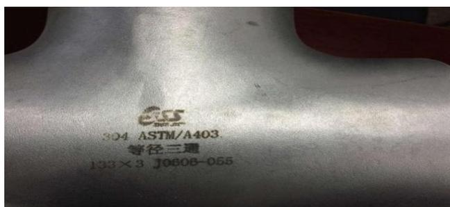
此产品名为等径三通，材质为 304，执行标准为 ASTM/A403，尺寸为 133\*3，炉号为 J0606-055，三通为管件、管道连接件，用在主管道要分支管处。等径三通是三通的一种，三通有一般等径三通，异径三通两种。因为三端可以与管子连接而命名；等径三通广泛应用于石油化工、石油天然
